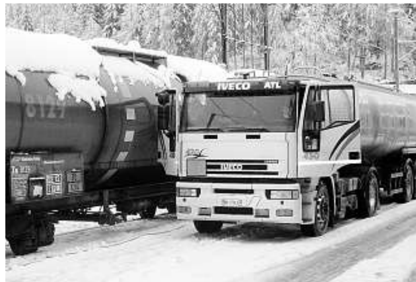
Von der Strasse auf die Schiene: Vom Lastwagen aus wird in Miralago Heizöl in einen Kesselwagen der RhB gepumpt.
